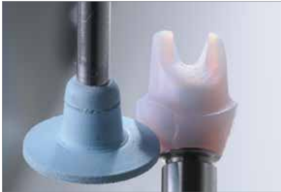
Vorpolitur mittels diamantierten Gummipolierer.
