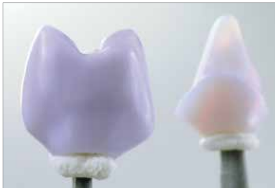
Wichtig: IPS e.max CAD Crystallization Pin XS nur leicht in das IPS Object Fix Putty/Flow eindrücken, so dass dieser die Wandung der Keramikstruktur nicht berührt.
