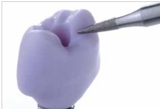
Okklusalfäche der Keramikstruktur mit feinem Diamanten überschleifen, um das CAD/CAM bedingte Oberflächenrelief zu glätten.
