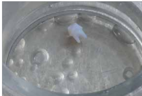
Reinigung mittels Ultraschall im Wasserbad ...
