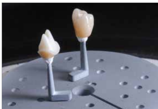
Nach Abschluss des Brennvorganges (Signalton Brennofen abwarten) Keramikstrukturen aus dem Brennofen nehmen.
